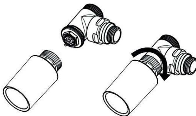
La testa termostatica si adatta a tutte le valvole con filetto del vitone M30x1,5. Non è consentito montare la testa termostatica in posizione verticale, in nicchie e non deve essere coperta da tende. L'elemento sensibile non deve essere posizionato all'esposizione diretta dei raggi solari.
